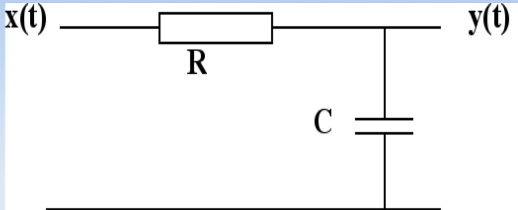
Effettuate le sostituzioni si procede al calcolo della tensione di uscita del partitore secondo i classici metodi dell'elettrotecnica (leggi di Ohm generalizzate).
