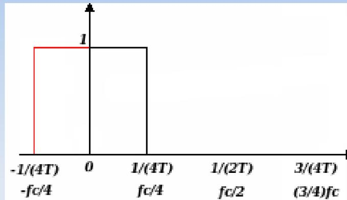
Per ottenere coefficienti del FIR che siano reali (cioè non contengano parte immaginaria) è necessario ipotizzare che la risposta del filtro sia simmetrica rispetto all'asse delle ampiezze (cioè nel semipiano delle frequenze negative).
