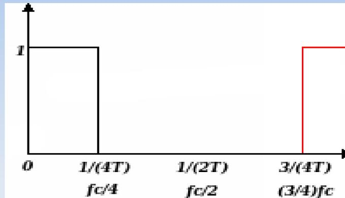
Riportiamo ora la parte negativa della risposta a completare la periodicità  $0 \rightarrow fc$  (frequenza di campionamento) della risposta simmetrica del nostro passabasso ideale:
