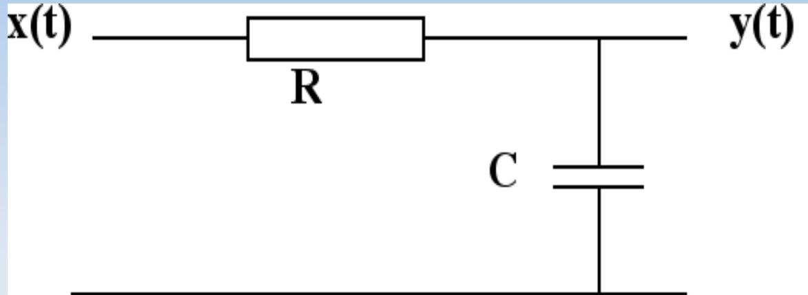
Per iniziare si ottiene la risposta  $H(s)$  del filtro analogico con la trasformata di Laplace.
